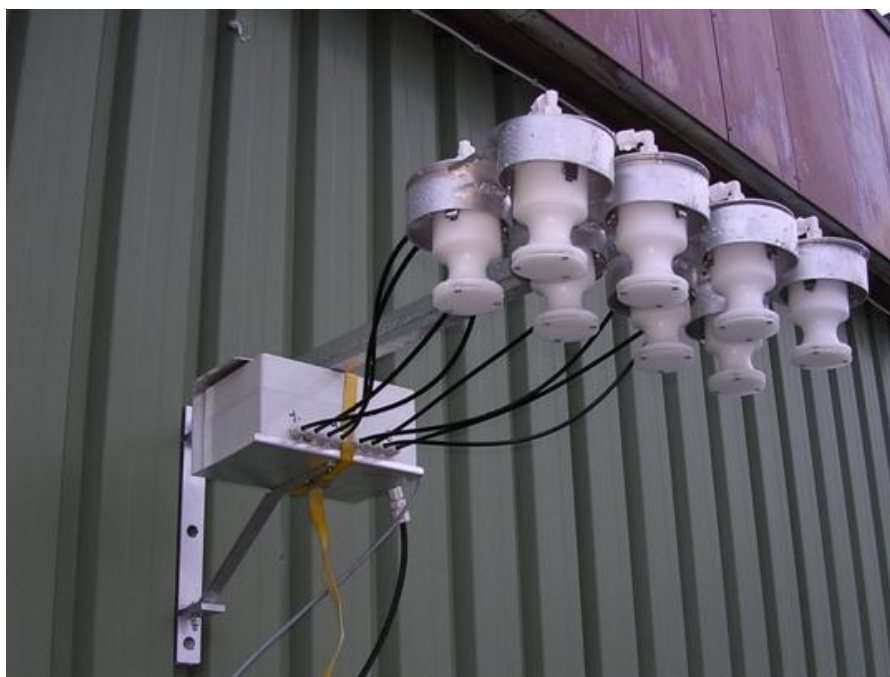
Bild 1. Provtagningsutrustning för partiklar (PM 10 ) (foto: Miljöinspektör Malin Persson)
